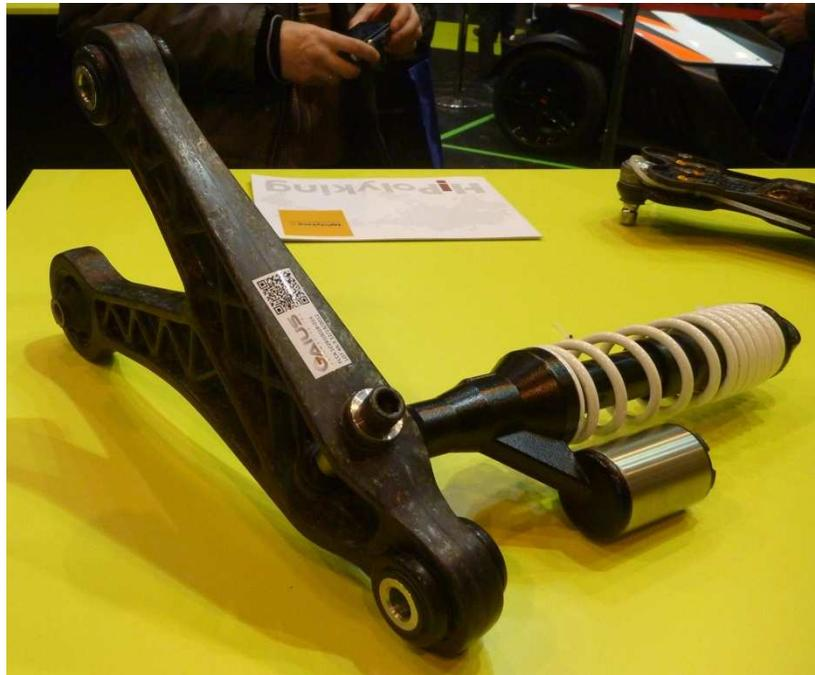
*Рычаг подвески автомобиля, изготовленный из углепластика.*
