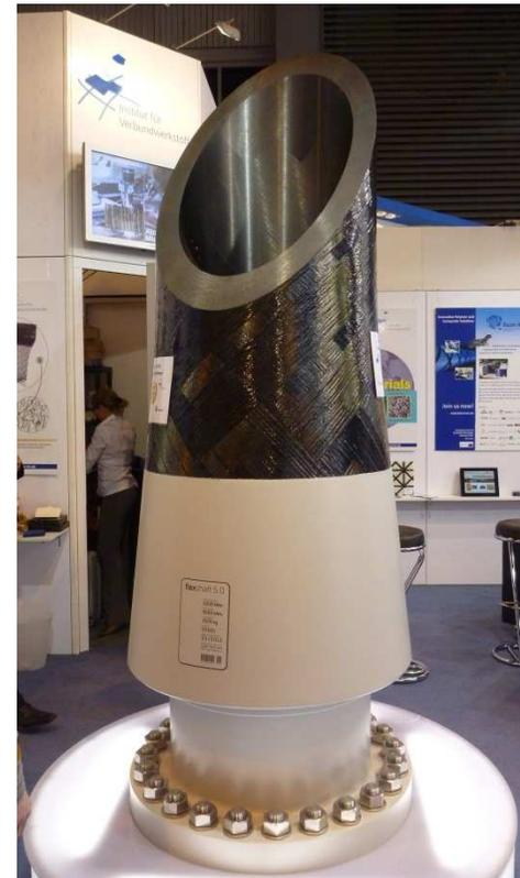
*Часть стойки ветрогенератора, изготовленная из углепластика.*
